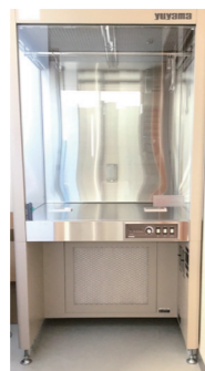
クリーンベンチ 無菌の状態 調剤を行える スペースを確保。
